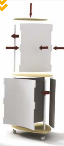
Tył i przód stoiska oraz sposób montażu poszczególnych elementów
